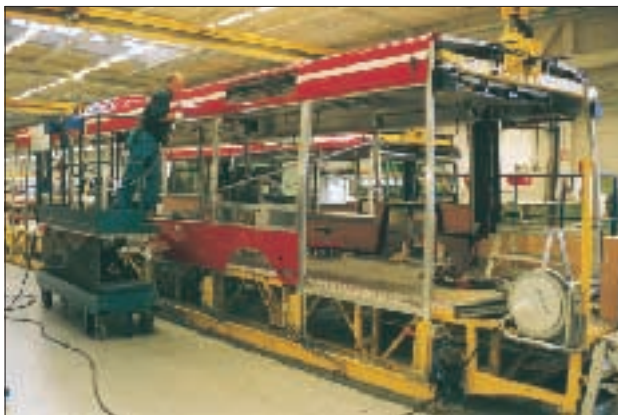
Bussrutor monteras med ett lim som inte innehåller isocyanater.
