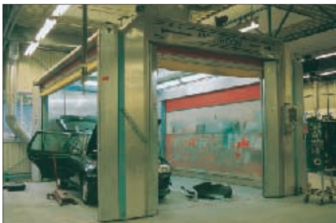
Mobilt rum som kan användas för att avskärma isocyanatarbete från övriga verkstaden.
