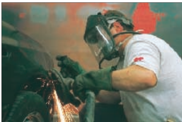
Användning av tryckluftsmatat andningsskydd vid slipningsarbete.
