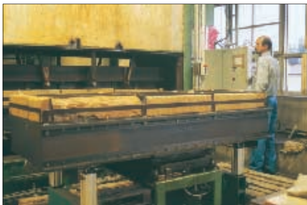
Formpressning av mineralull vid hög temperatur
