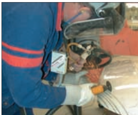
Samtidig mätning med impingerflaska och det direktvisande instrumentet isologgen vid kapningsarbete.
