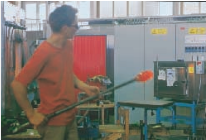
Inom glasindustrin placeras det heta glaset på dukar innehållande PUR. Detta går sedan igenom avsvalningsugnen som håller en hög temperatur, varvid isocyanater frigörs.
